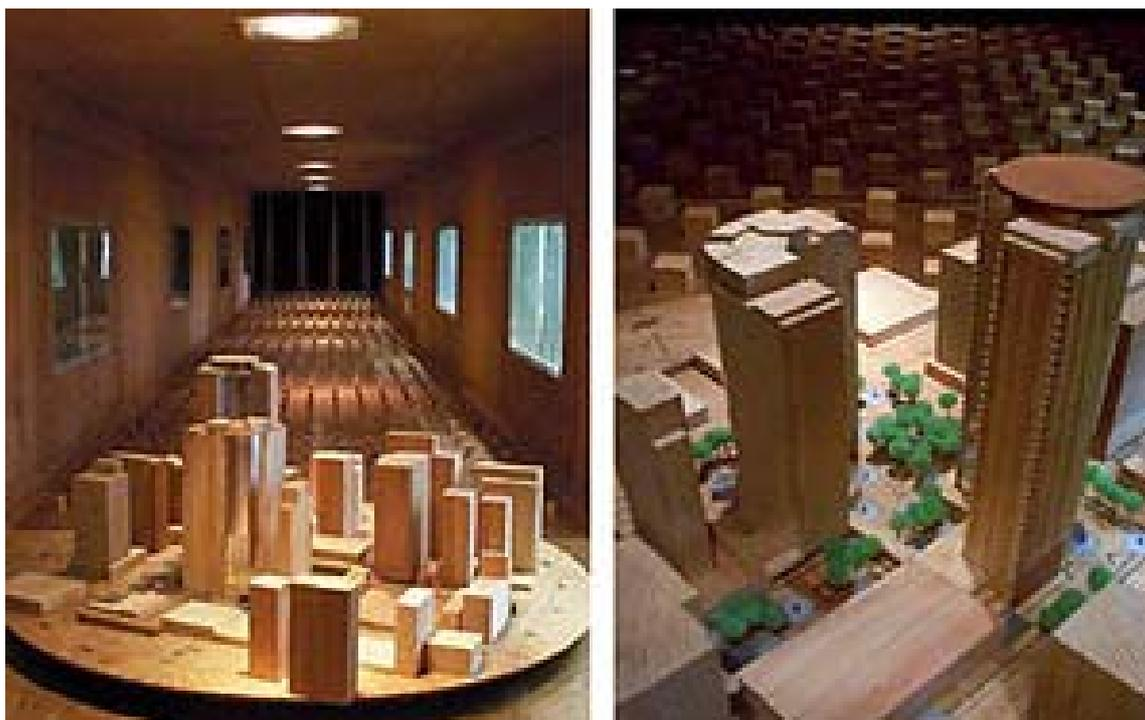
**Figura 3.2 – Ensaio no túnel de vento.**
